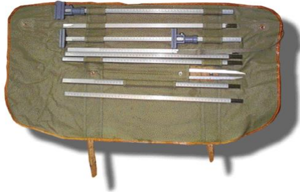
صورة 9: مقياس أنثروبومتر سيبر-هجنر Siber-Hegner في حقيبة حمل
