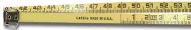
صورة 7 قراءة الشريط: قم بمحاذاة علامة الصفر مع المقياس العلوي: هنا القراءة 48.9 سم.
