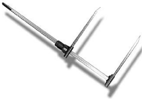
صورة 11 مقياس أنثروبومتر سيبر هيغنر على شكل فرجار منزلق كبير.
